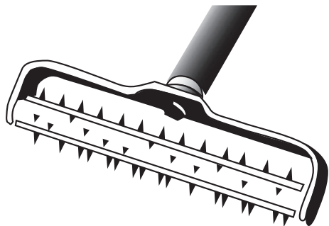
Рис. 3.21. Игольчатый валик для накалывания гипсокартона перед его замачиванием
