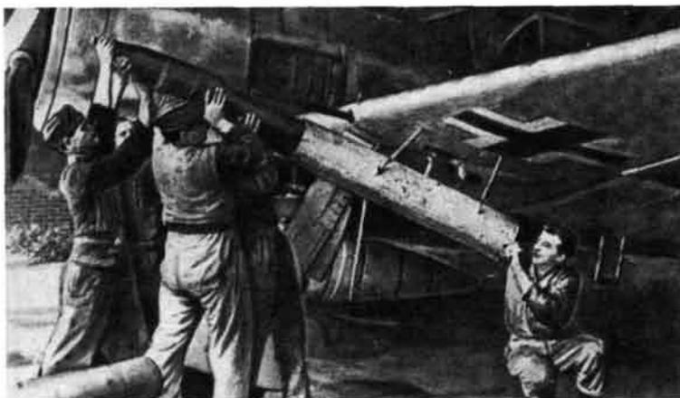
Снаряжение реактивной пусковой установки Wfr.Gr.21 на FW190A-7/R6
