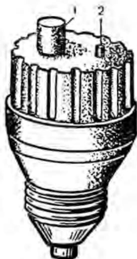
**1** – кнопка включения; **2** – кнопка отключения
