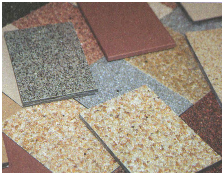
Плитка из керамогранита не имеет блестящей глазурованной поверхности, так как она предназначена для покрытий пола
