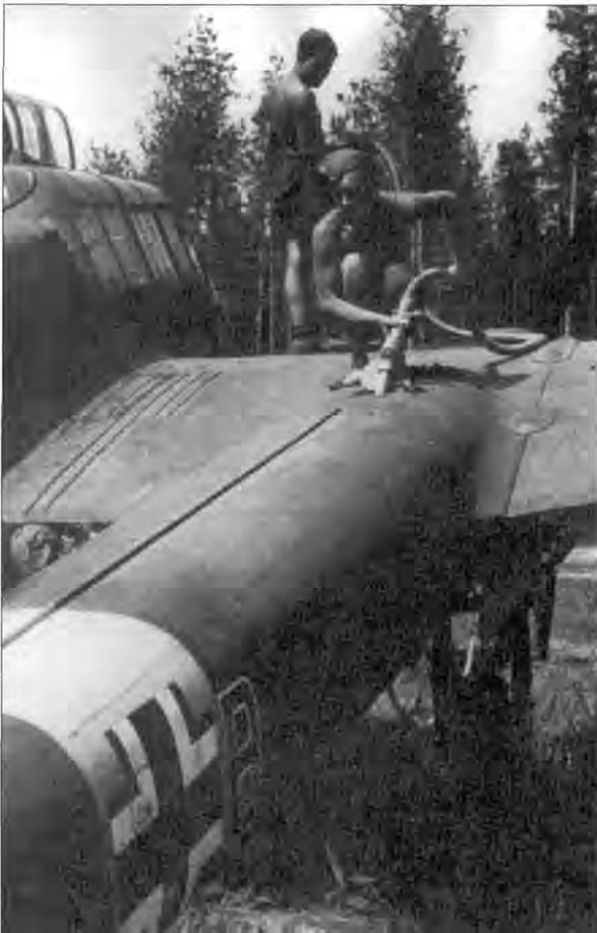
*Техники заправляют горючим самолет Fw-189A, Восточный фронт, лето 1943 г. В каждой плоскости крыла разведчика были расположены по два топливных бака емкостью по 110 л. Обратите внимание на наплывы в месте стыка плоскости крыла и центроплана, наплывы закрывают узлы крепления плоскости к центроплану.*
