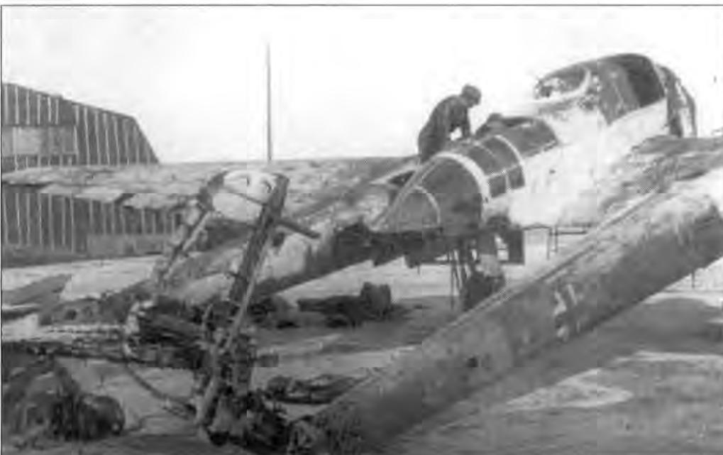
*Этот Fw-189 получил значительные повреждения при грубой посадке на передовом аэродроме. Машину списали, технический персонал использовал самолет в качестве источника запасных частей для других разведчиков.*
