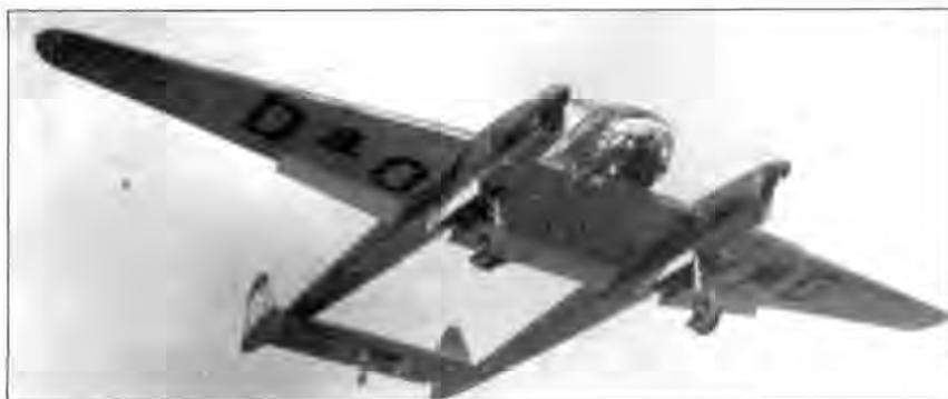
*Второй прототип Fw-189V-2 имел регистрационный код «D-OVHD». От первой опытной машины Fw-189V-2 отличался только наличием вооружения. Под плоскостями крыла смонтированы бомбодержатели.*
