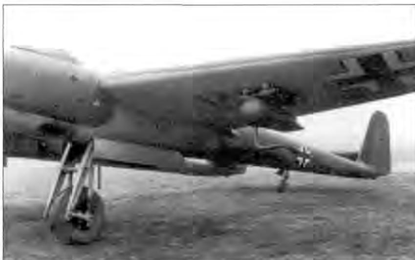
*На Fw-189V-6 проходил испытания контейнер для распыления химических отравляющих веществ; контейнер подвешивался на штатный бомбодержатель ETC-50/VIII.*
