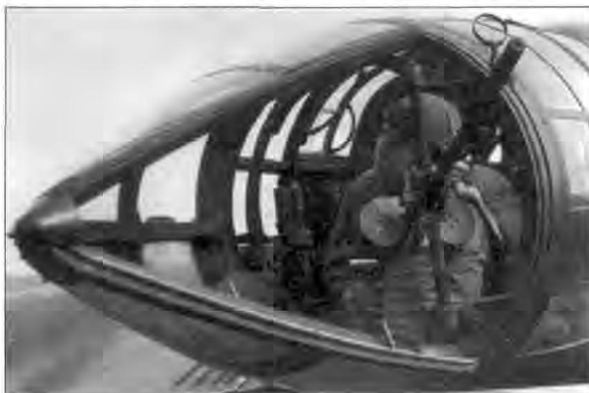
*Качественный снимок кормовой оборонительной стрелковой установки самолета Fw-189A-1. Пулемет MG-15 снаряжался двойным дисковым магазином.*
