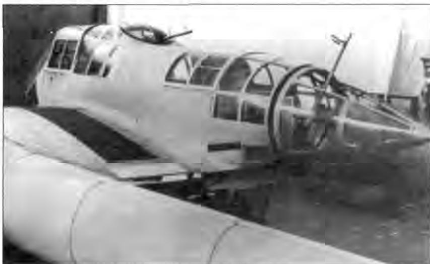
*Оборонительное вооружение разведчика Fw-189A-1 состояло из двух пулеметов MG-15 калибра 7,9 мм. Стрельбу из пулеметов вели радист и бортмеханик.*
