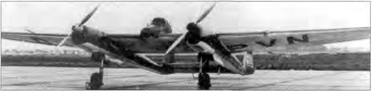
Самолет Fw-189V-6 имел регистрационный код «D-OPVN». Буквы кода наносились черной краской на хвостовые балки и на нижнюю поверхность крыла. Позже трубчатые основные опоры шасси заменили на стандартные рамные опоры серийных самолетов.
