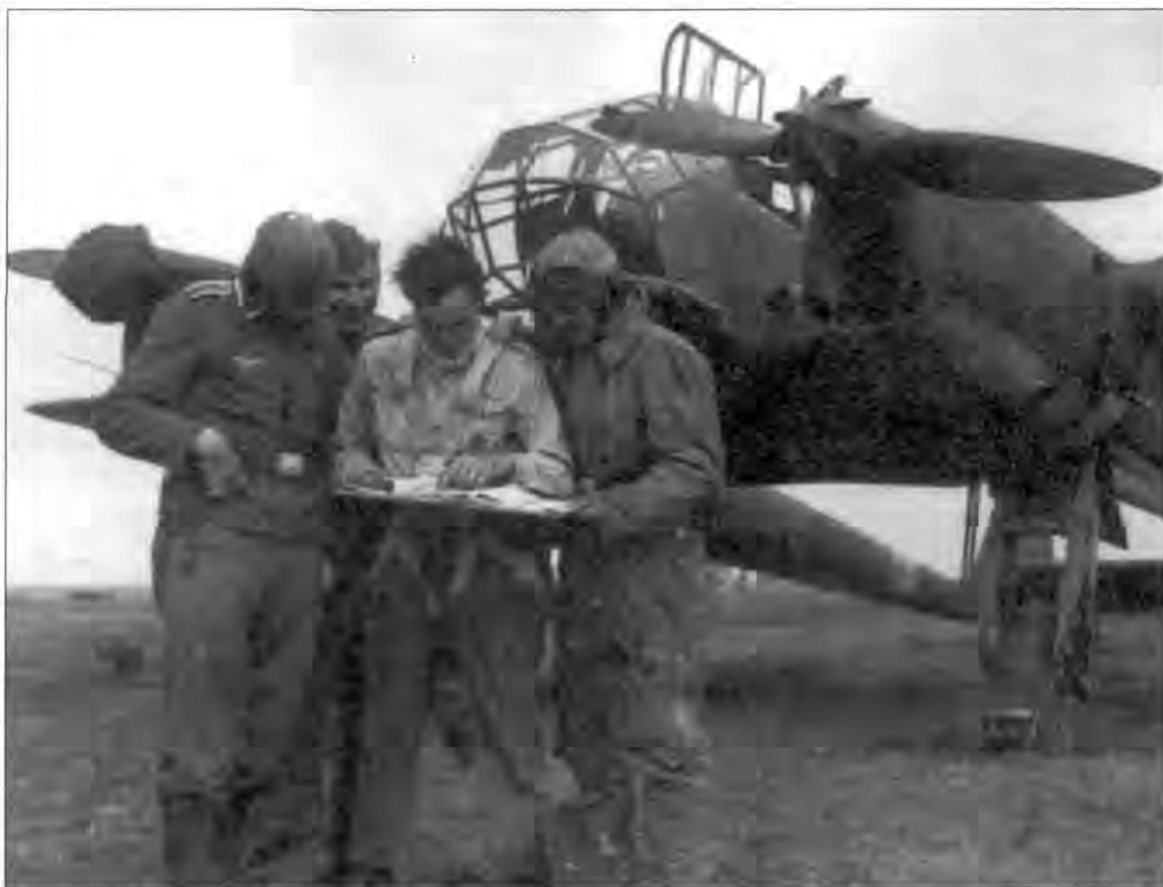
*Экипаж разведчика Fw-189A-1 одного из штаффелей люфтваффе обсуждает очередное задание, Восточный фронт. Экипаж Fw-189A состоял из трех человек: летчика, стрелка-радиста и бортеханика-воздушногo стрелка. На снимке в кромке центроплана между центральной гондолой и мотогондолой хорошо виден срез трубы, в которой смонтирован ствол 7,9-мм пулемета.*
