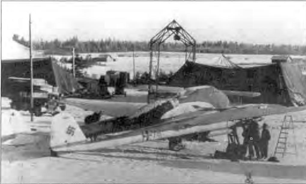
*Зимой работу технического состава эскадрилий ближней тактической разведки сильно осложнял мороз. На стоянках центральные gondолы и двигатели разведчиков закрывались утепленными чехлами. Обслуживание самолетов на морозе никому не доставляло радости.*
