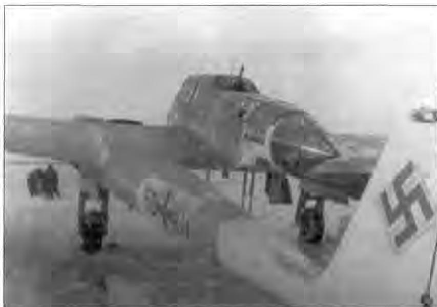
*Разведчик Fw-189A-1 из I.(H) 31, самолет имеет бортовой код «SD+KH». Самолет имеет зимнюю окраску, нанесенную поверх стандартного камуфляжа, опознавательные знаки и места нанесения бортового кода в белый цвет не красились.*
