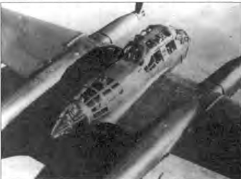
Двигатель As-411MA-I развивал на взлетном режиме мощность 580 л.с., на высоте 610 м - 600 л.с.
