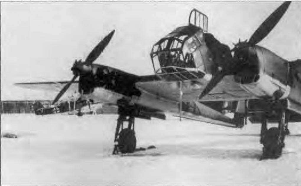
*Разведчик Fw-189 на заснеженном русском аэродроме, на заднем плане - самолет Хейнкель He-46. Fw-189 несет характерных для самолетов люфтваффе, задействованных на Восточном фронте, желтых полос вокруг хвостовых балок. Судя по отсутствию чехлов на капотах двигателей, самолет подготовлен к полету.*
