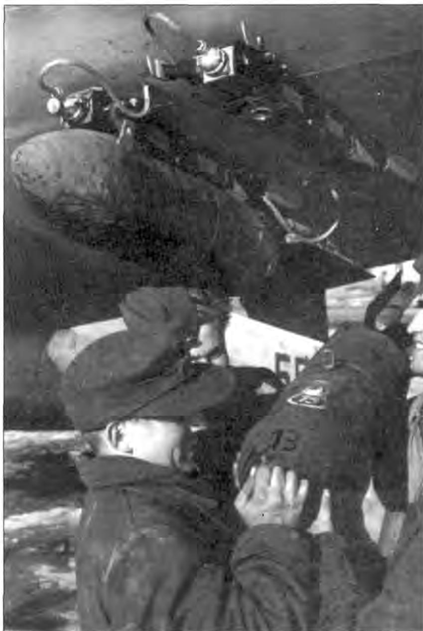
*Техники готовятся к заправке разведчика Fw-189A, Восточный фронт. На снимке хорошо видны два небольших воздухозаборника маслорадиатора. Некоторые Fw-189A имели мачты радиоантенн в верхней части центральной gondolly, но на всех самолетах обязательно монтировалась нижняя мачта, на фотографии - выше заправочного шланга.*
