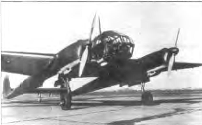
*Третий прототип Fw-189V-3. Сначала самолет имел гражданский регистрационный код «D-ORMH», замененный со временем военным кодом люфтваффе «GJ+RT», на снимке - самолет уже с обозначениями люфтваффе. Третий прототип имел основные опоры с одной круглой стойкой и оснащался штатными моторами Аргус As-410 с винтами изменяемого шага.*
