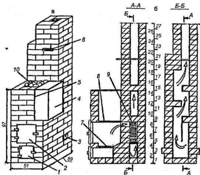
**Рис. 7. Малогабаритная печь-каменка с верхним размещением бака для воды:**
