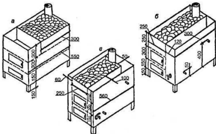
**Рис. 5. Печи-каменки с встроенным баком для воды:**
