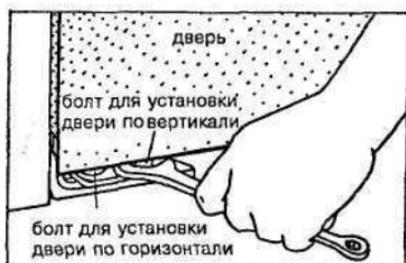
Рис. 17. Регулировка положения двери
