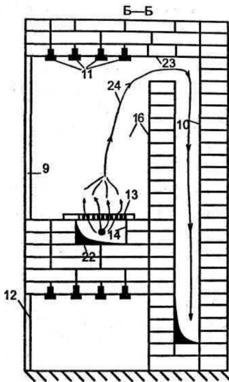
*Рис. 19. Устройство двухкамерной коптильни
