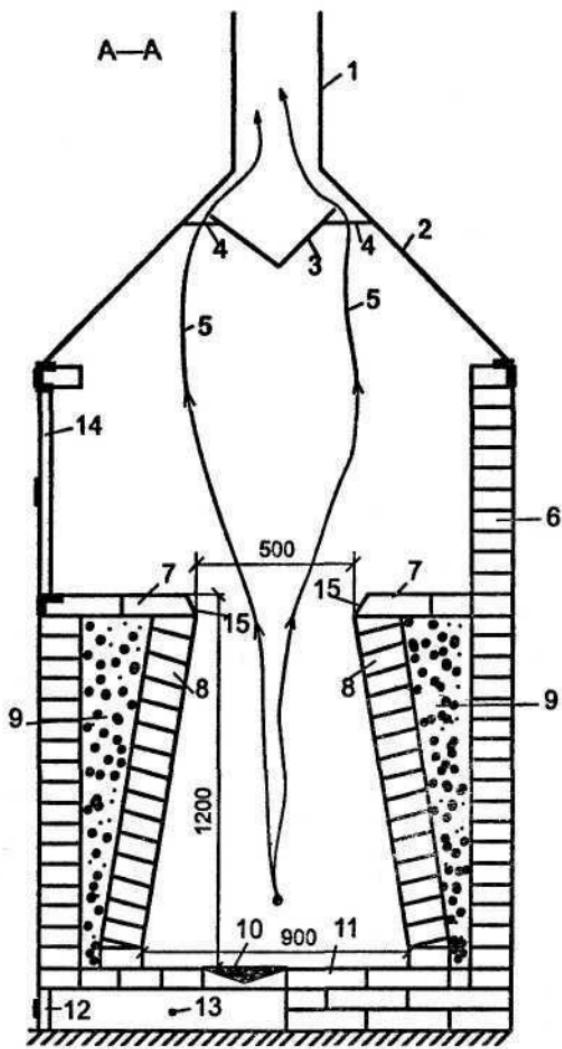
Рис. 12. Устройство печи — тандыра, разрез А—А:
