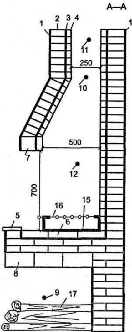
Рис. 2. Устройство барбекю, разрез А—А:
