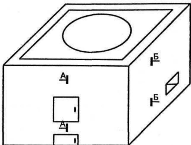
Рис. 7. Схема печи-топливника для установки азиатского казана
