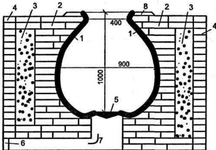
Рис. 16. Устройство усовершенствованной азиатской печи — тандыра № 2:
