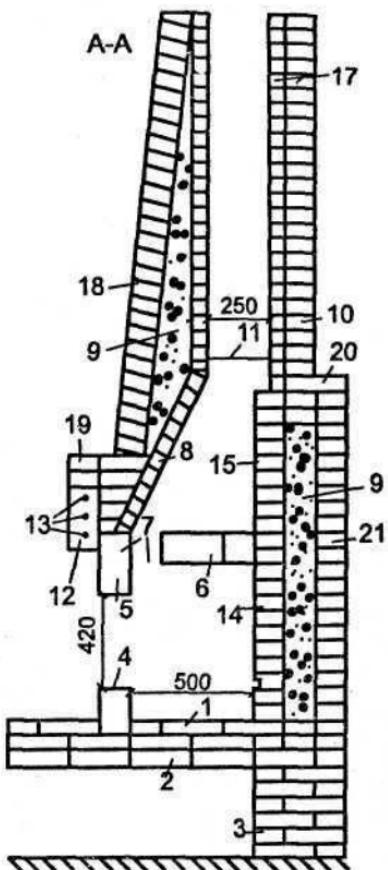
Рис. 28. Устройство уличного камина в разрезе А — А:
