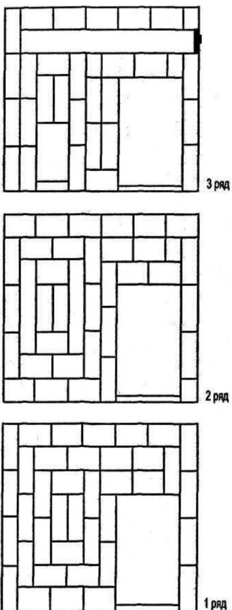
Рис. 22. Схемы кладки двухкамерной коптильни
