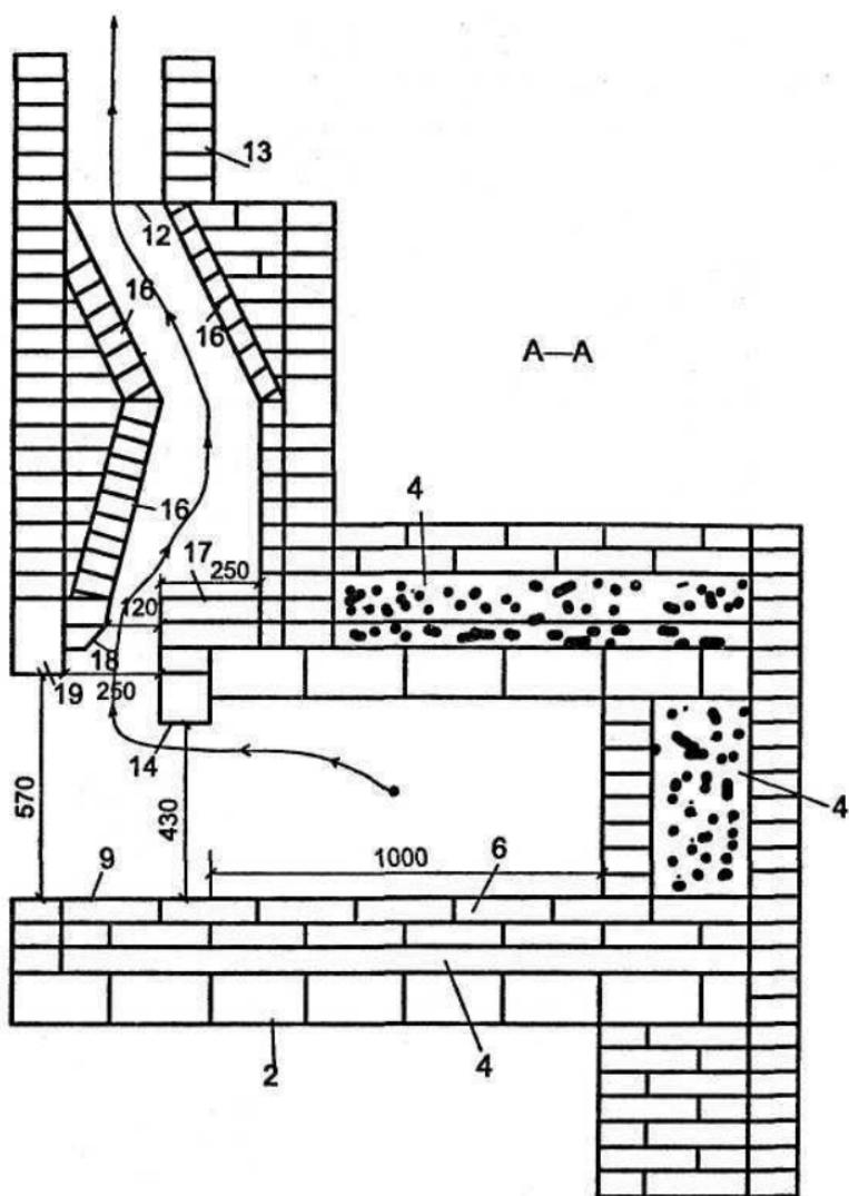
Рис. 24. Устройство уличной русской печи в разрезе А—А:
