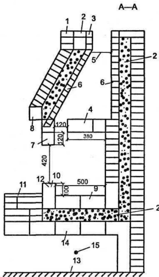
Рис. 5. Устройство духовой печи — мангала, разрез А — А:
