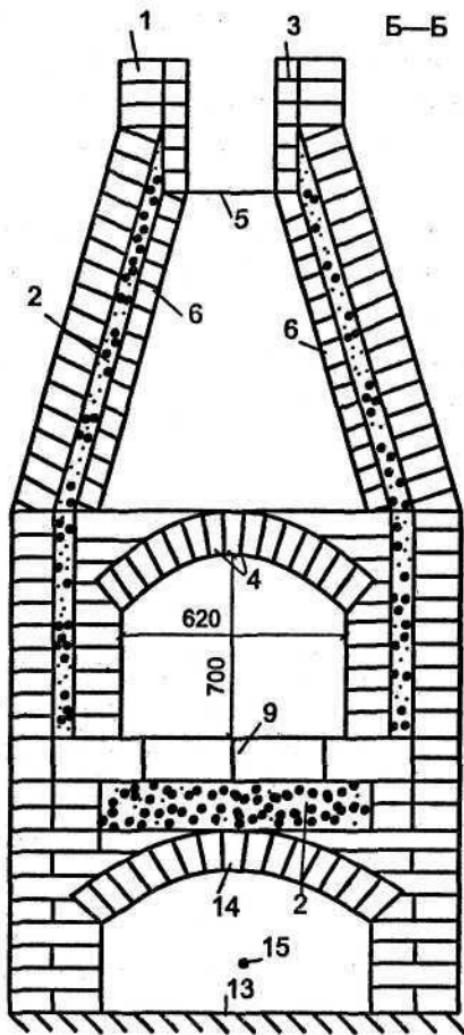
*Рис. 6. Устройство духовой печи — мангала,
