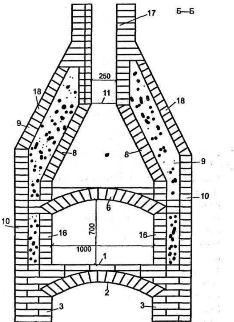
Рис. 29. Устройство уличного камина в разрезе Б — Б
