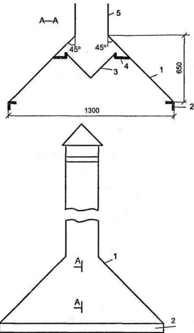
*Рис. 13. Стальной дымосборник для усовершенствованной печи — тандыра:*
