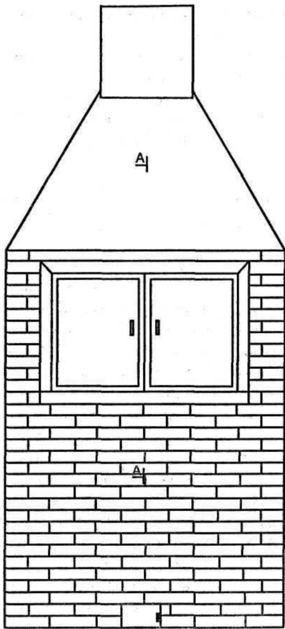
Рис. 11. Эскизный проект усовершенствованной азиатской печи — тандыра № 1
