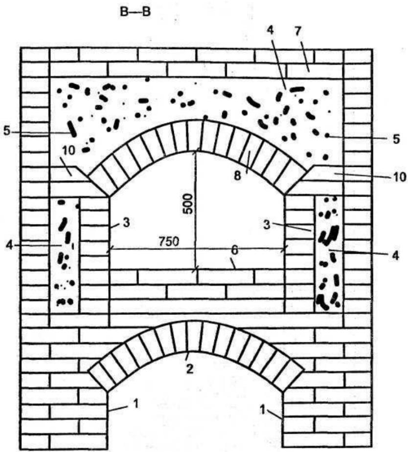
*Рис. 26. Устройство уличной русской печи в разрезе В—В
