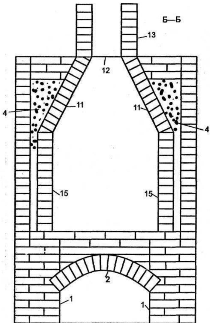
Рис. 25. Устройство уличной русской печи в разрезе Б—Б
