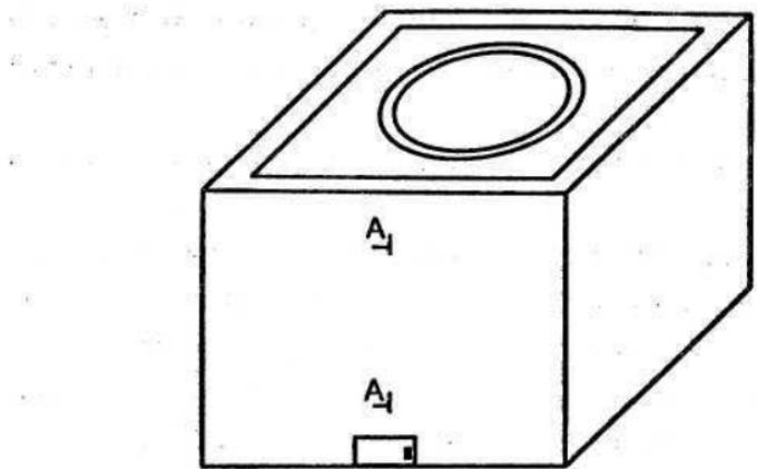
Рис. 15. Эскизный проект усовершенствованной азиатской печи — тандыра № 2
