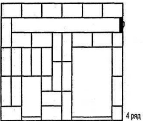
Рис. 22. Схемы кладки двухкамерной коптильни
