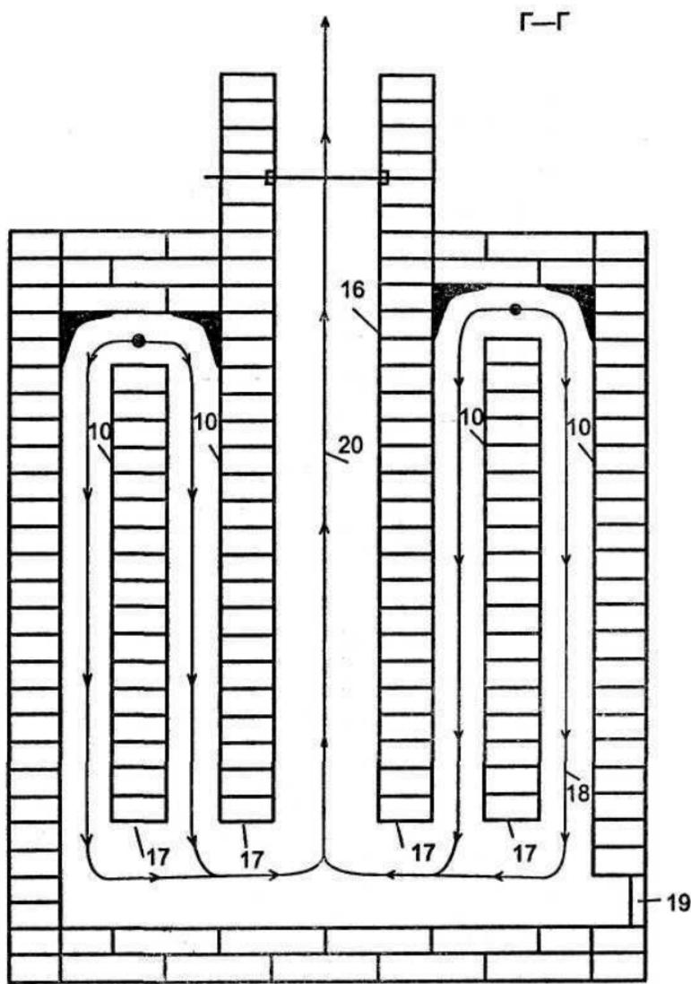
*Рис. 21. Устройство двухкамерной коптильни
