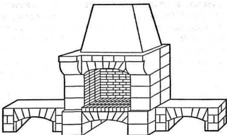
Рис. 25. Эскиз камина облицованного керамической плиткой ручной работы
