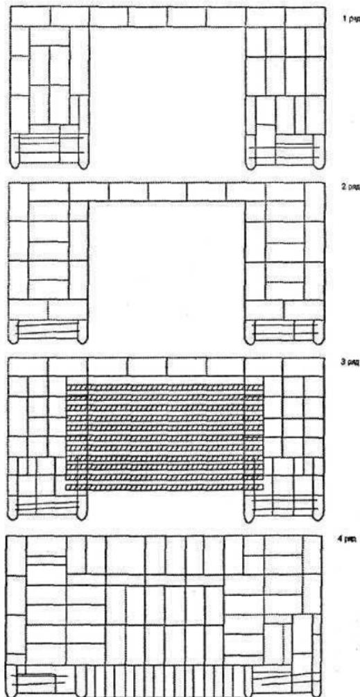
Рис. 8. Порядовка кладки камина (конструкции В. В. Селивана)
