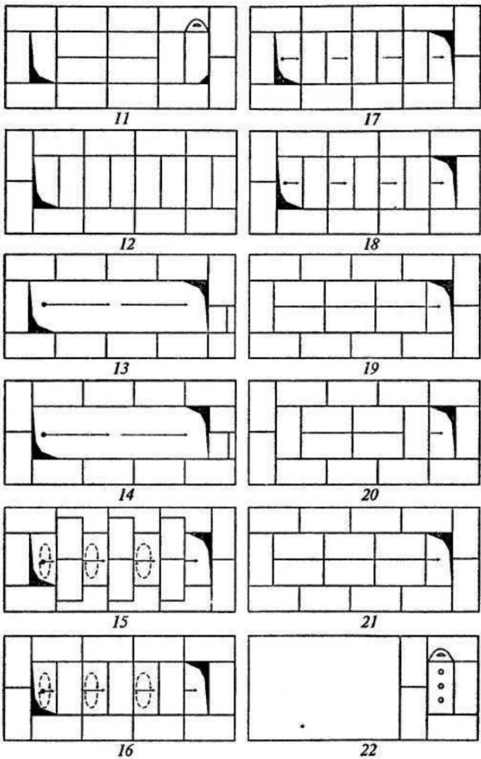
Рис. 3. Порядок кладки отопительного щитка
