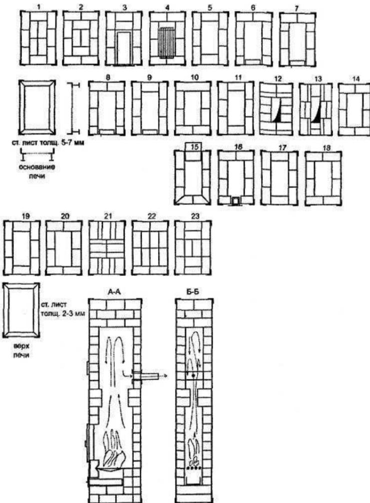
Рис. 10. Печь отопительная каркасная (конструкции В. В. Селивана) в разрезах А-А, Б-Б. Порядковка кладки
