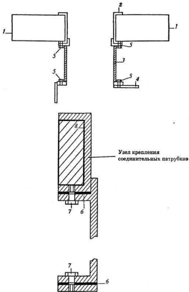
**Рис. 6. Узел соединения отопительного щитка и стального топливника:**
