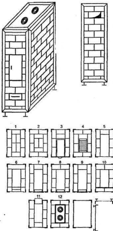
Рис. 11. Кухонная плита-очажок (конструкция В.В. Селивана)
