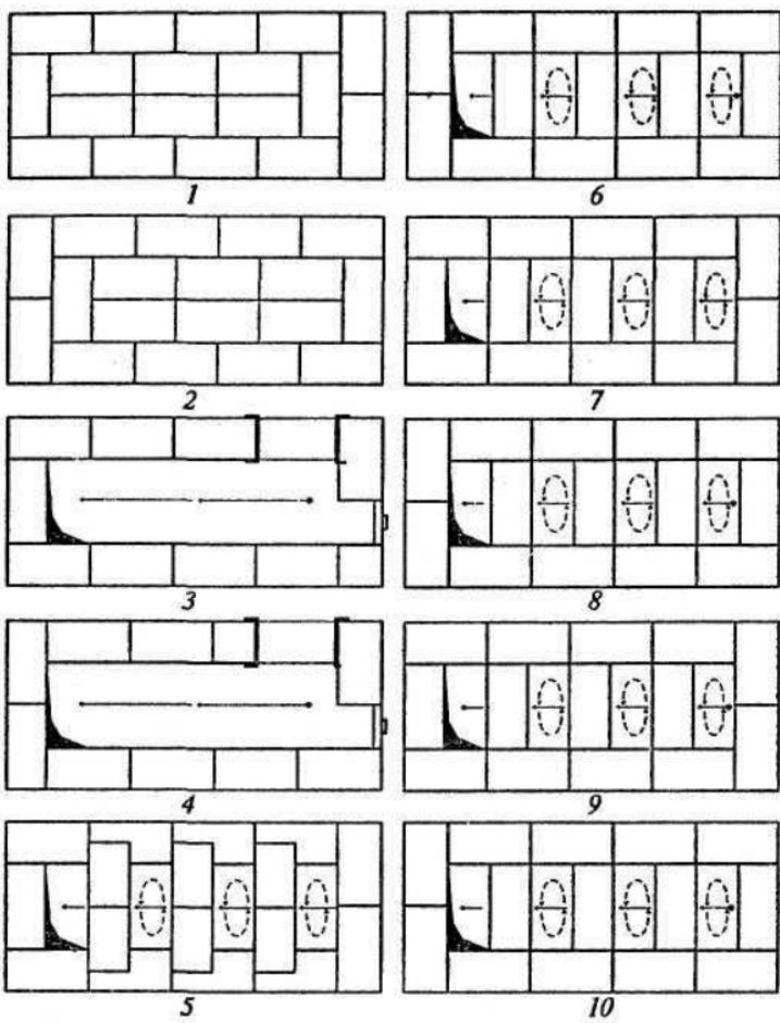
**Рис. 3. Порядовка кладки отопительного щитка к банной печи**
