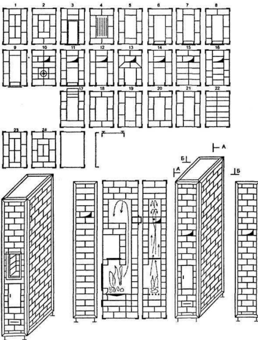
Рис. 12. Печь отопительно-варочная (конструкции В. В. Селивана)
