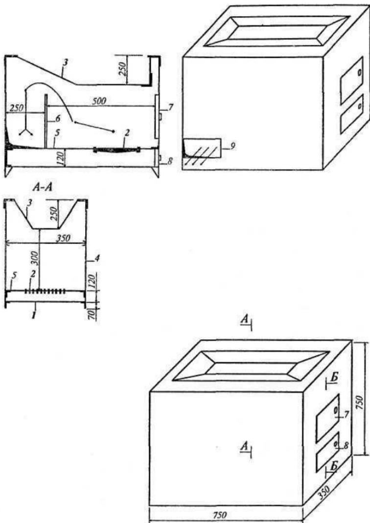
Рис. 4. Устройство стального топливника для банный печи:
