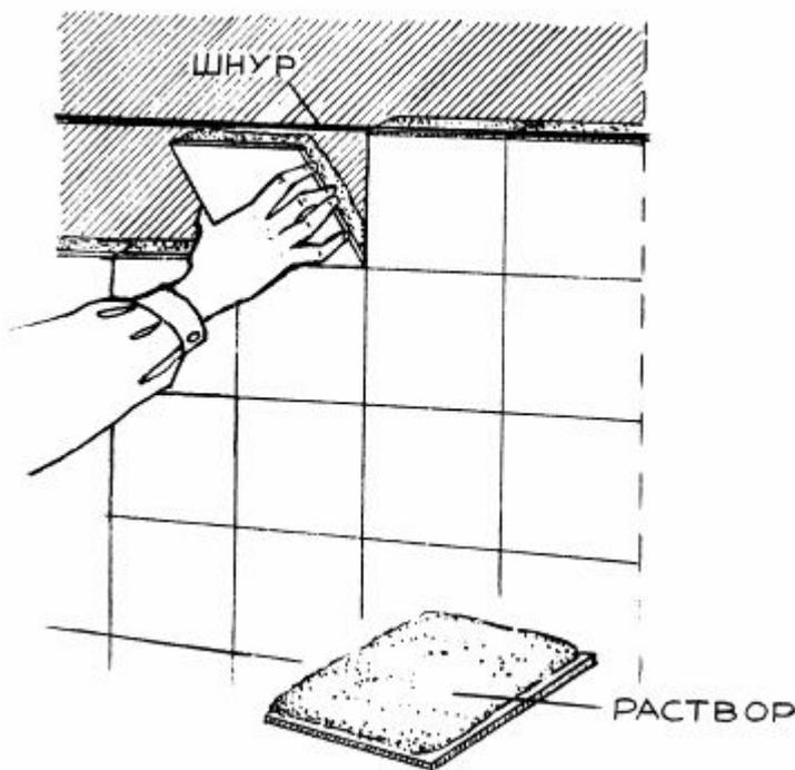
После укладки первого, нижнего ряда плиток приступают к укладке второго ряда. Необходимо точно придерживаться вертикальных линий разметки. Особое внимание следует уделить угловому переходу. Его необходимо точно промерить и закрепить все промеры натянутыми ниточками, но его облицовку рекомендуется производить после выкладки первого нижнего ряда угловой стены.
