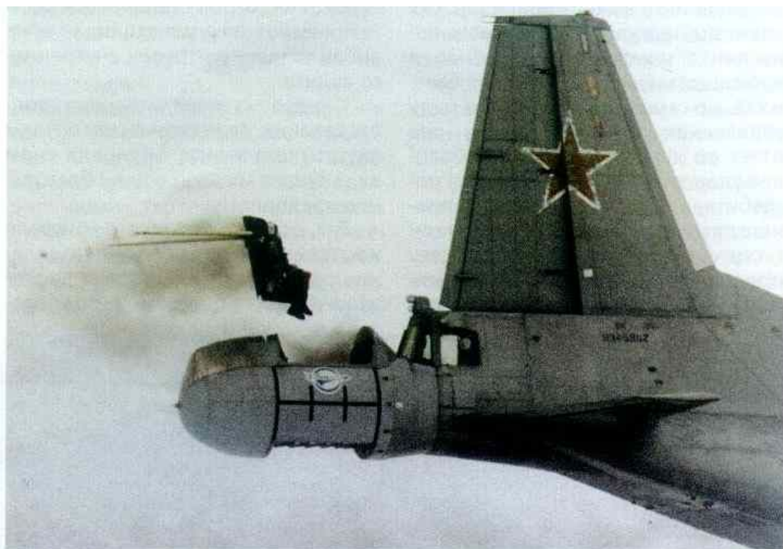
Катапультирование К-36Д-3.5А в России из летающей лаборатории Ан-12
