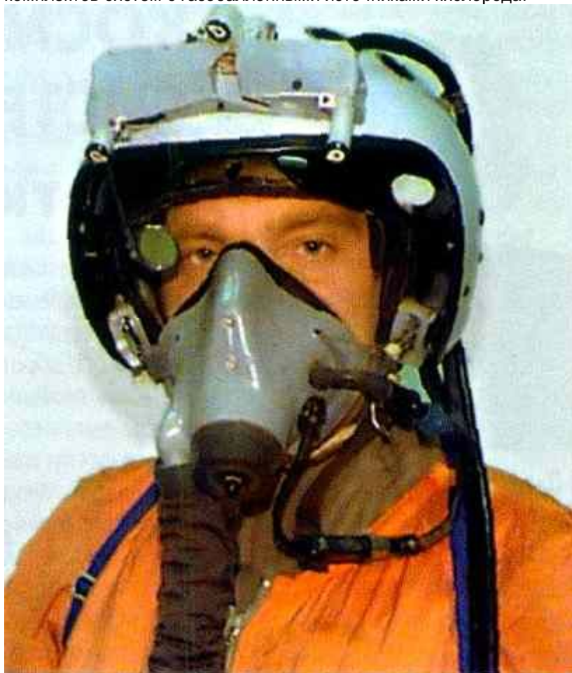
Защитный шлем ЗШ-7АПН с электронно-оптическим визиром НВУ-7
