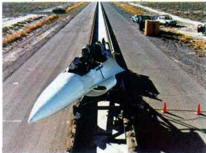
Испытания К-36Д в США на ракетном треке авиабазы Holloman при угле рыскания кабины 20 град
