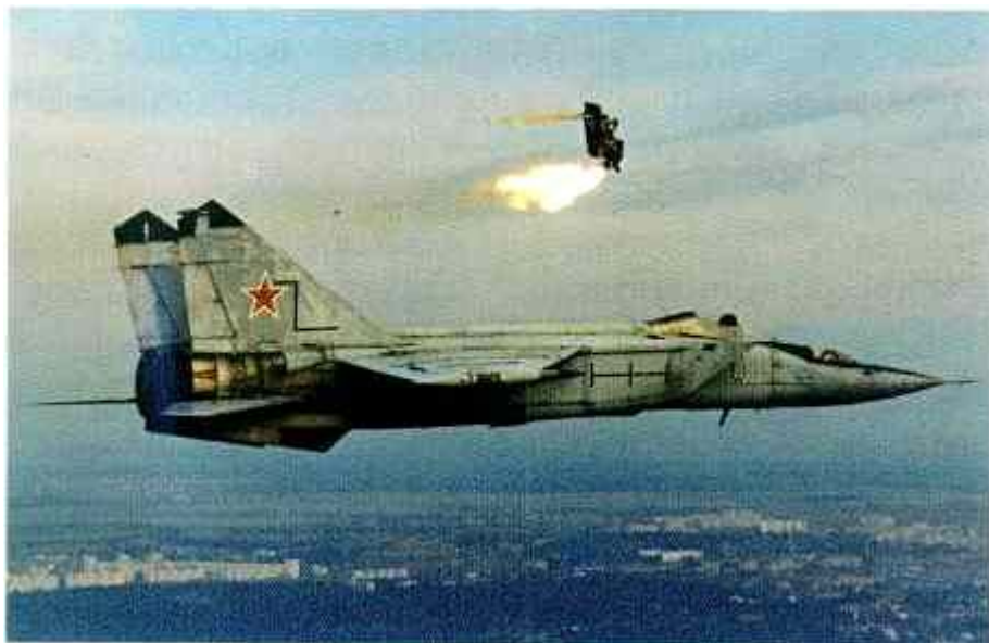
Катапультирование К-36Д-3.5А в России из летающей лаборатории МиГ-25
