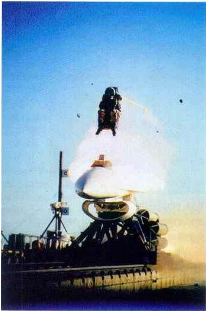
Катапультирование K-36Д-3.5А в США на ракетном треке авиабазы Holloman при V_i=1300 км/час
