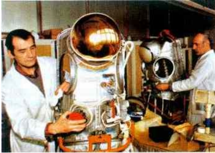
Сборка скафандров типа "Орлан" в испытательной лаборатории предприятия
