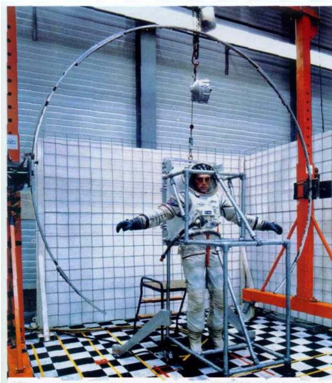
Эргономический макет скафандра СК ВКД-2000 во время испытаний на фирме "Сабка" (Бельгия)
