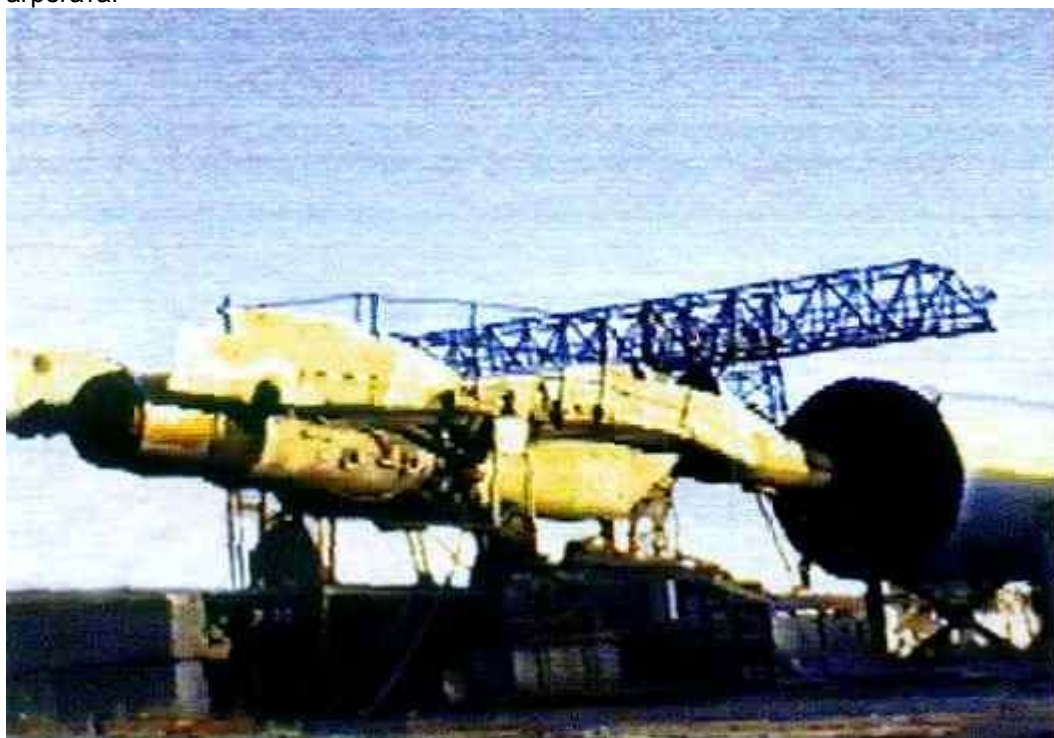
Аэродинамический стенд для испытаний систем пожаротушения
