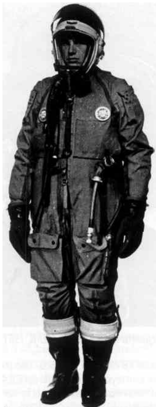
Высотный морской спасательный комплект ВМСК-2 (включает компенсирующий костюм ВКК-6П и гермошлем ГШ-4МП), 1959 г.
