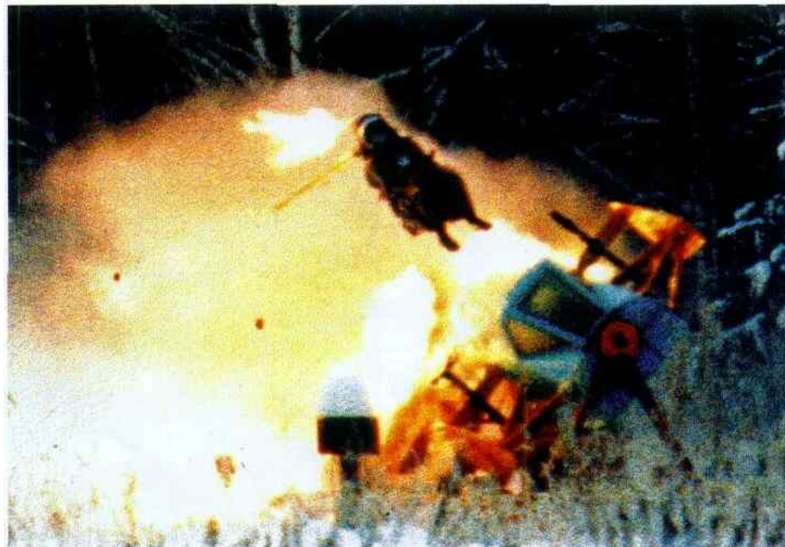
Катапультирование К-36Д-3,5 в России на ракетном треке РД-2500 при вращении кабины по крену с W_x=3,5 1/с
