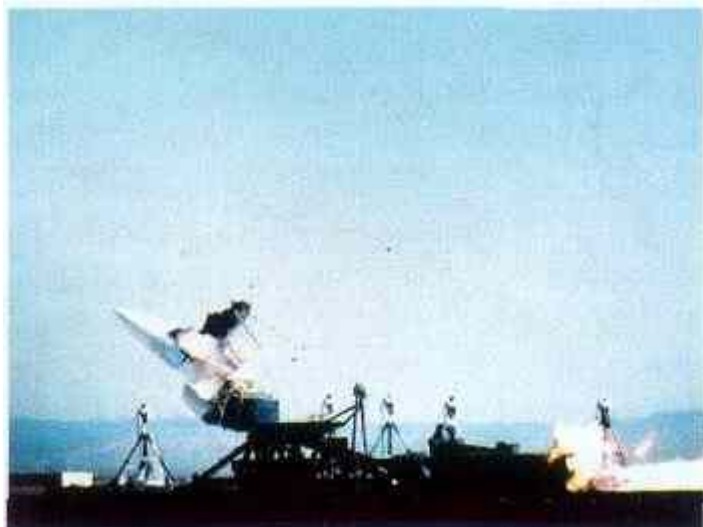
Испытания К-36Д в США на ракетном треке авиабазы Holloman при угле тангажа кабины 30 град
