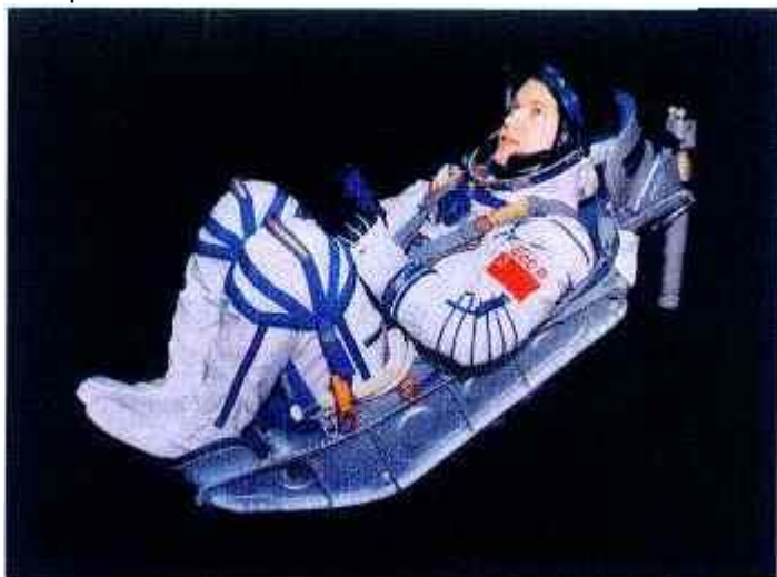
Амортизационное кресло "Казбек" с испытателем в спасательном скафандре "Сокол"
