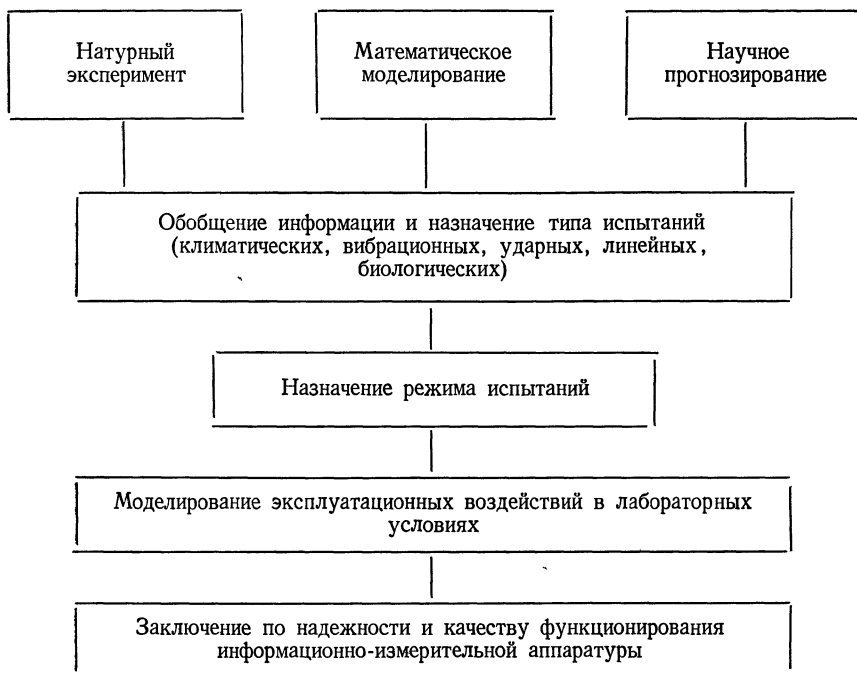
Рис. 71. Схема проведения испытания изделий при моделировании механических воздействий
