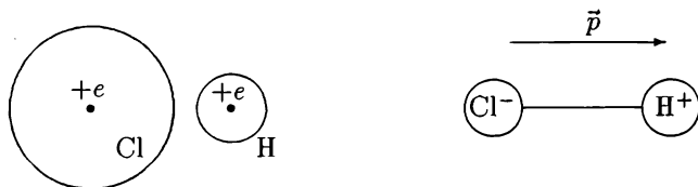
Рис. 2.2. Две модели молекулы соляной кислоты. Отрицательный заряд всех 18 электронов распределен в основном около атома хлора. Молекула \text{HCl} является полярной
