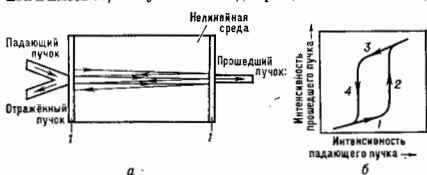
Рис. 6. Интерферометр Фабри — Перо как оптический нестабильный элемент (а) и петля гистерезиса зависимости интенсивности прошедшего пучка от интенсивности падающего пучка (б): 1 — полупрозрачные зеркала.
