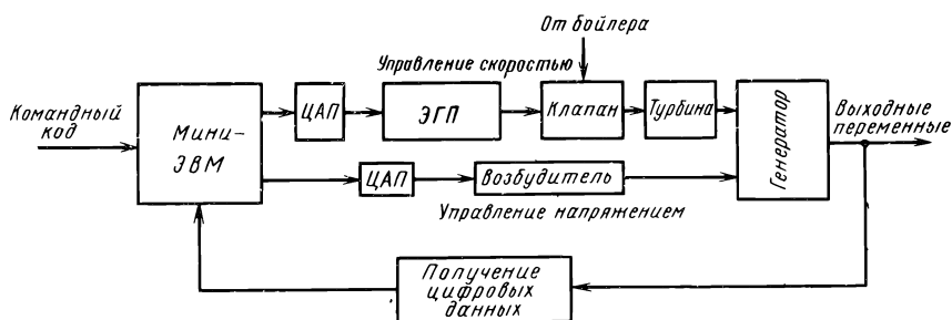
Рис. 1.12. Цифровое управление блоком турбина—генератор: ЭГП – электрогидравлический преобразователь
