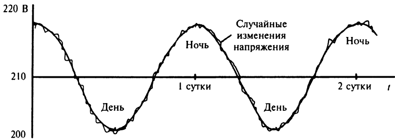
Рис. 9.2. Изменения напряжения питания в течение суток
