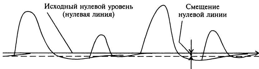
Рис. 10.16. Смещение нулевой линии в спектрометре и искажение амплитуды сигнала
