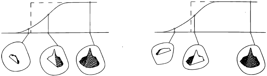
Рис. Д2.8. Построение графиков функций рассеяния полуплоскости для двух взаимно-перпендикулярных положений полуплоскости. Под графиком показаны фигуры, объем которых прямо пропорционален освещенности в соответствующей точке графика. Пунктирной линией дан график изменения освещенности в идеальном изображении.
