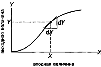
Рис. 4.2. Определение чувствительности при нелинейной характеристике.
