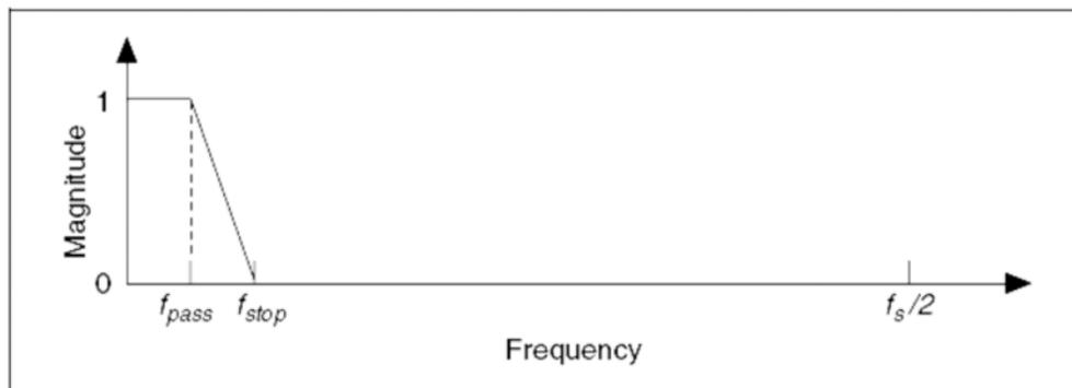
Рис. 16.49. АЧХ заданного фильтра с передаточной функцией  $H(z)$
